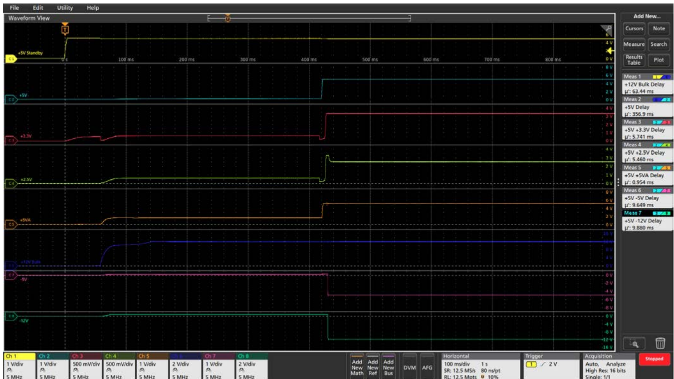
使用自动测量检定电源启动特点。
