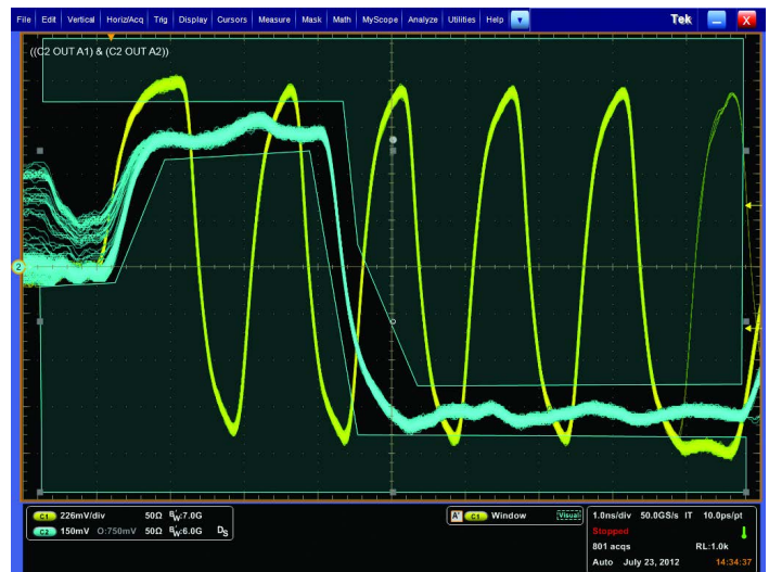
DDR 内存。可视触发用来隔离 DDR3 特定码型上偶发的写突发。触发事件是由 11000000 组成的 Write DQ 突发，这时，DQ 发起从非三态电压值开始。DDR 内存总线事件涉及时钟通道、选通通道和数据通道以及数据的多个幅度和突发。
