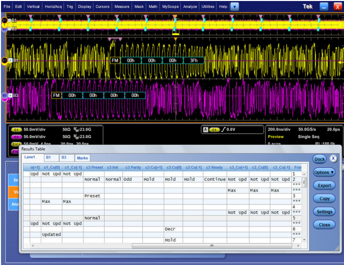
链路调训 (选项HSSLTA) - 根据快帧记录提供互动结果表 - 快帧记录: 时间校准十六进制和位级解码、标记(帧、控制通道和调训数据)。结果表: 所有协商数据均采集在结果表中。单击行以查看波形、滚动表行、验证协商请求/响应和导出协商数据。
